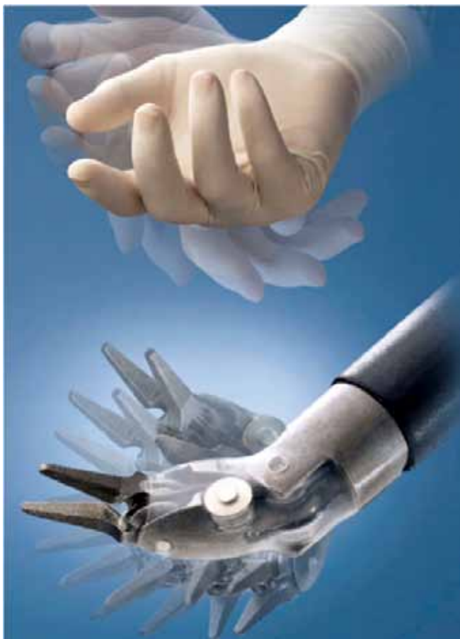
Figura 3. “Endowrist”, braços cirúrgicos simulam os movimentos do punho humano.
