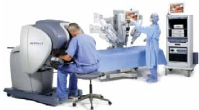
Figura 2. Sistema robótico “Da Vinci S” constituído de console cirúrgico, torre de vídeo e conjunto de 4 braços robóticos (Câmera + 3 braços multiarticulados)
